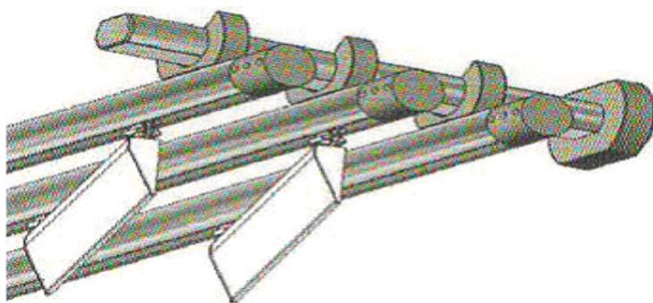
"Treger" panel sistem je kombinacija "Treger" alu sistema i Oriente panel sistema tj. paneli su od Oriente čičak profila i pripadajućih dijelova koji idu uz taj profil (klizači, čepovi panela i aluminijski uteg). Montira se isključivo na zid, spada u jedno od najboljih estetskih rješenja sa panelima u prostoru
